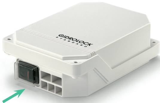
Фото 1. Блок управления GIDROLOCK STANDARD. Переключатель «Сеть» со встроенным индикатором включения питания, отверстия для ввода кабелей питания, управления шаровыми электрическими приводами, датчиков протечки воды
