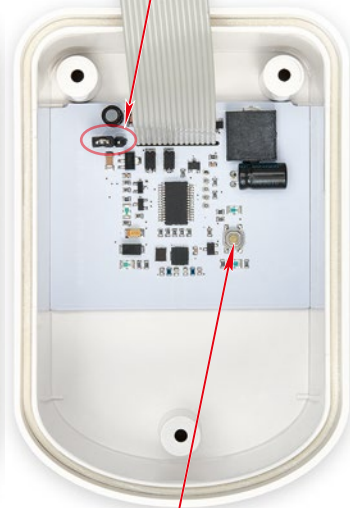
Фото 7. Элементы управления на внутренней стороне крышки шарового электропривода
