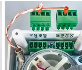
Фото 18. Подключение проводного выключателя к электроприводу
