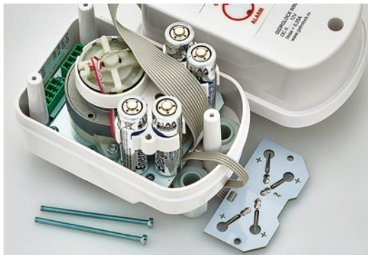
Фото 31. Контактная площадка снята, батарейки могут быть заменены
